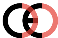
Marcatura CE contraffatta (troppo vicino)
